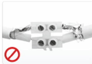
Kabler med forkerte eller dårlige samlinger
