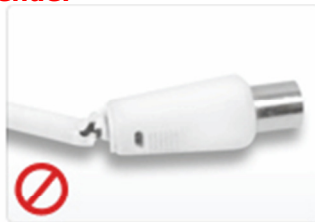
Kabler med synlige skader
